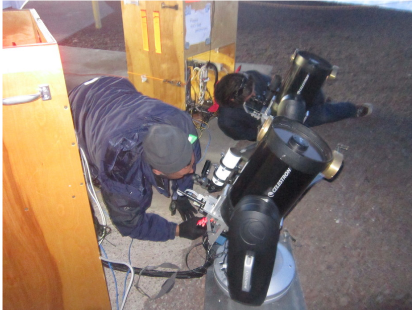
FIGURE 8 – Les deux Ikis (télescopes de 8 pouces) et leur module informatique. Phase de mise en station des télescopes.
