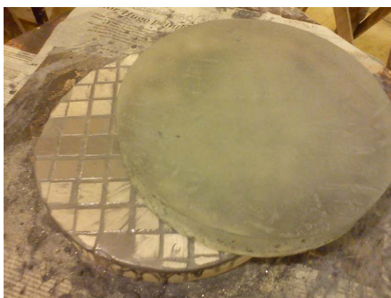
© Manuela Raimbault Outil phase d'ébauchage fait de plâtre et carreaux de céramique ; abrasif : carborundum.
