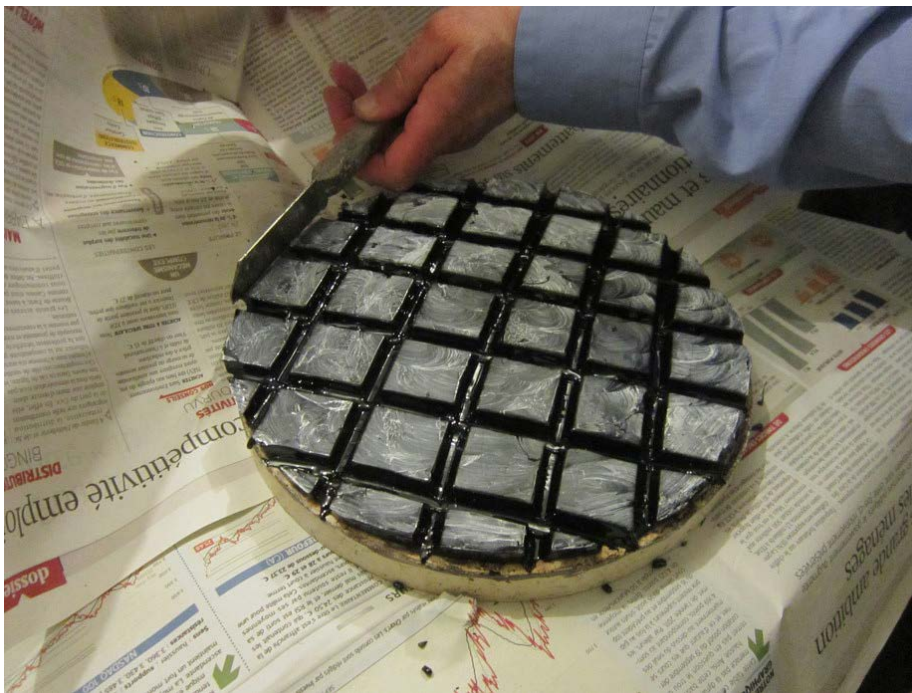
© Manuela Raimbault Outil phase de polissage, carreaux de poix ; abrasif : cérium.
